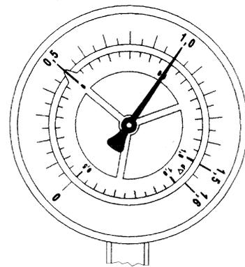
Die Skizze zeigt die Ausführung DRD 100/xxx.9xx/.... Ein Zeiger ist normal, der andere in Kreisform ausgeführt. Auf dem kreisförmigen Zeiger bewegt sich die Skala für den Differenzdruck mit. Auf dem obigen Beispiel liegt am linken Anschluss 0,5 bar an, am rechten Anschluss liegt 1 bar an. Die Differenz von 0,5 bar kann auf der kreisförmigen beweglichen Skala abgelesen werden.
